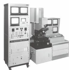
1976年LSIフォトマスク欠陥検査装置
