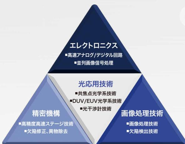
光を用いた検査・計測の可能性を徹底して追究するなかで、光源にレーザーを使用して高解像度化を図った「レーザー顕微鏡」の開発に成功し、これを出発点に、全焦点で高精細な3次元画像が得られる「**共焦点光学系技術**」を確立しました。さらに、半導体リソグラフィの微細化に伴う光源の短波長化に適応した「**DUV/EUV光学系技術**」、光の位相のわずかなずれを正確に測定する「**光干渉計技術**」を独自に開発してきました。
