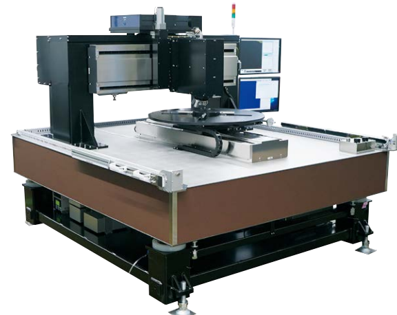
XYストローク 800 mm×1,000 mm ガントリー門柱型顕微鏡
